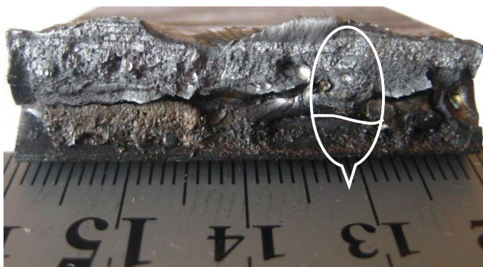
Рисунок 14 Вид образца со стороны скоса после вскрытия
