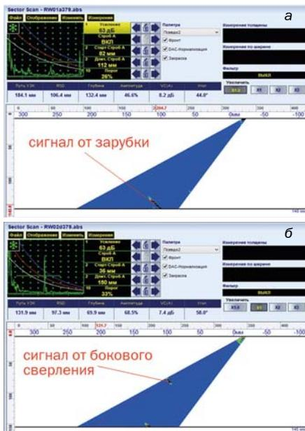
Рис. 15. Выявление отражателей с использованием дефектоскопа Isonic 2010, контроль с внутренней поверхности, схема прозвучивания DR 3.1; а — акустическое изображение пропила; б — акустическое изображение бокового сверления диаметром 5 мм на глубине 70 мм от поверхности
